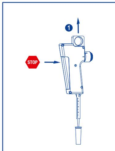
Auto-serraggio del grilletto quando il liquido rimasto non è sufficiente. Tirare l'asta verso l'alto al fine di aspirare il liquido ❶.
